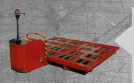
Der Mini-Donkey ist ein Elektro-Hubwagen für den horizontalen Transport von ULD's auf mobilen Slavepaletten MSP-4 mit einer Systemhöhe von 208 mm. Als Einsatzort ist der Hallenbereich in der kleinen Frachtabfertigung vorgesehen. Er dient als Transportmedium zwischen Land- und Luftseite.
